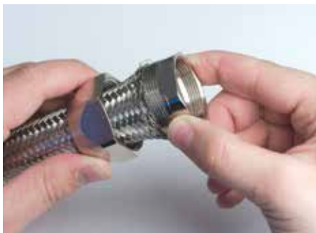
2. Установить промежуточный корпус под оплетку, предварительно удалив скотч с металлорукава. Плотно зафиксировать гайку и промежуточный корпус между собой, тем самым закрепив оплетку металлорукава в аксессуаре
